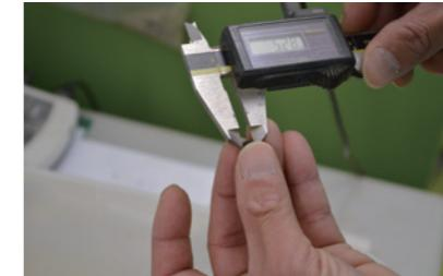
粒のサイズや熱処理など、工程ごとに管理ポイントを定めており、それら全てをクリアしたもののみ製品化されます。管理ポイントは全て記録保管し、実際の原料や製品サンプルも保管しているため、いつどこでどの原料から製造出荷したのかを速やかに追跡できます。
