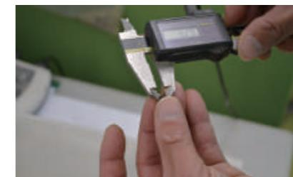
粒のサイズや熱処理など、工程ごとに管理ポイントを定めており、それら全てをクリアしたもののみ製品化されます。管理ポイントは全て記録保管し、実際の原料や製品サンプルも保管しているため、いつどこでどの原料から製造出荷したのかを速やかに追跡できます。
